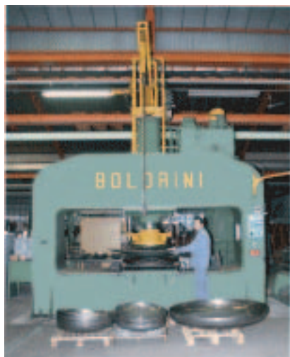
Machine à bomber les fonds capacité: dia. 3000 mm. / 400 tonnes
